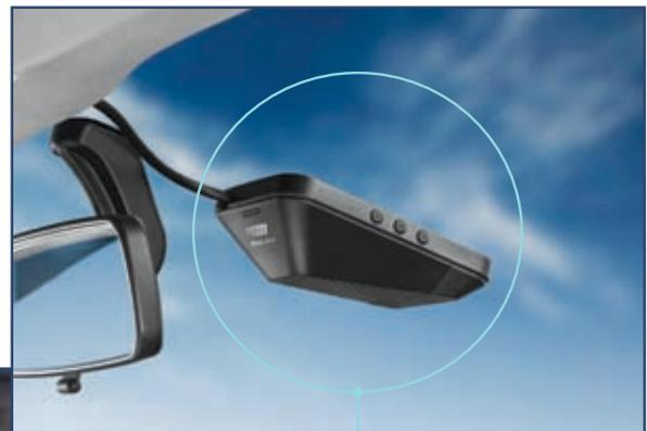
Die Kameraeinheit besteht aus der Kamera, dem EyeQ®-Chip und dem Lautsprecher, welche auf der Innenseite der Windschutzscheibe hinter dem Rückspiegel angebracht ist.
